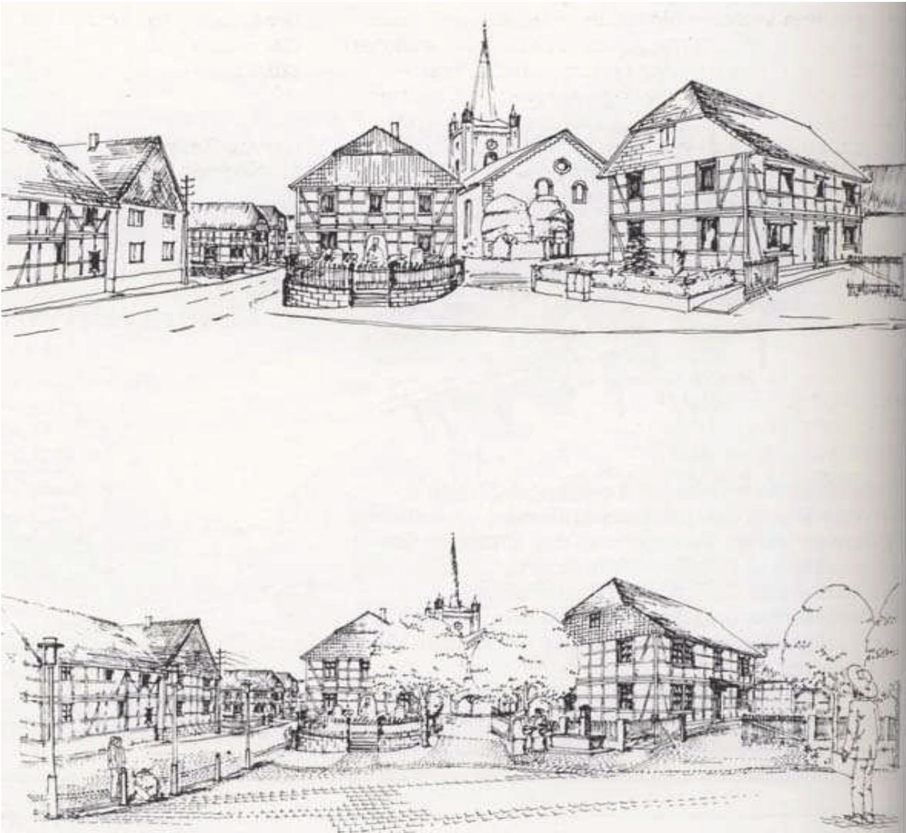
Dieses Beispiel von Verkehrsplanung zeigt, wie Straßen in ihrer Funktion und Bedeutung durch unterschiedliche Materialien verständlicher zu begreifen sind. Der Einmündungstrichter der untergeordneten Straße hat eine Aufpflasterung erhalten. Der Verkehrsfluss erhält eine andere Ausrichtung und Priorität. Die Grüninsel mit neuer Baumpflanzung markiert deutlich den veränderten Knotenpunkt.
