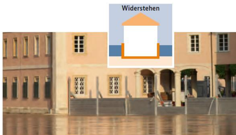
Widerstehen: zum Beispiel durch Objektschutz
